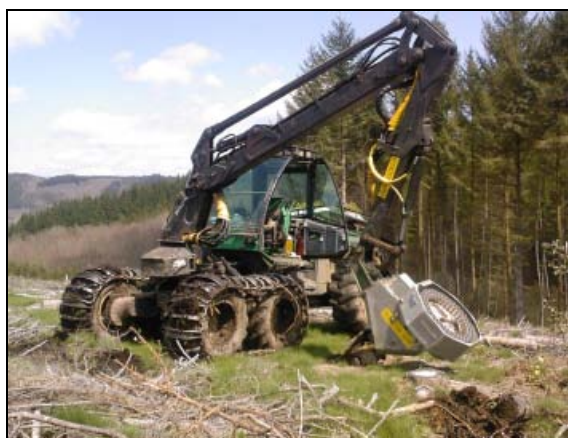
Le Bräcke Planter peut se monter sur un combiné d'abattage ou sur une pelle type « travaux publics ».
