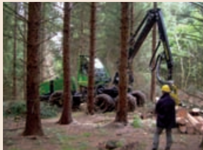
Abatteuse J. Deere 1270 DT3 en éclaircie d'amélioration en peuplement résineux.
