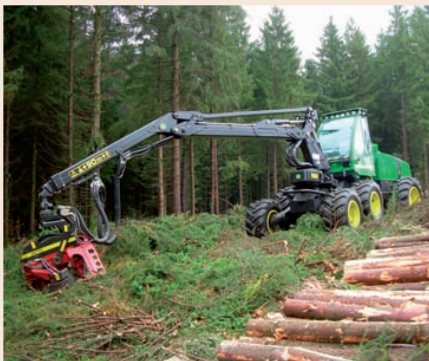
Abatteuse J. Deere 1270 DT3, matériel respectueux de l'environnement fonctionnant à l'huile hydraulique biodégradable.
